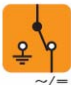
隔离开关和接地
